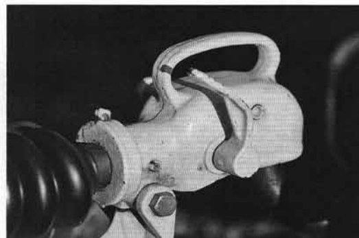
Anhängerkupplung mit Griff für leichtes Rangieren
